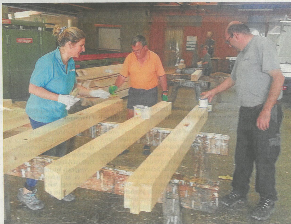
Die Balken werden im Zimmereibetrieb geölt.
